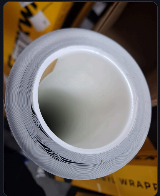
Tunneling an einer lose gewickelten Rolle: Liner und Folie trennen sich in Wellen.
